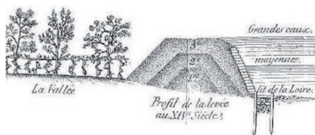
Schéma en profil d'une levée de la Loire au XIV e siècle (sources : étude risque inondation agglomération Nevers (egrian) historique au XII e siècle : les turcies).
